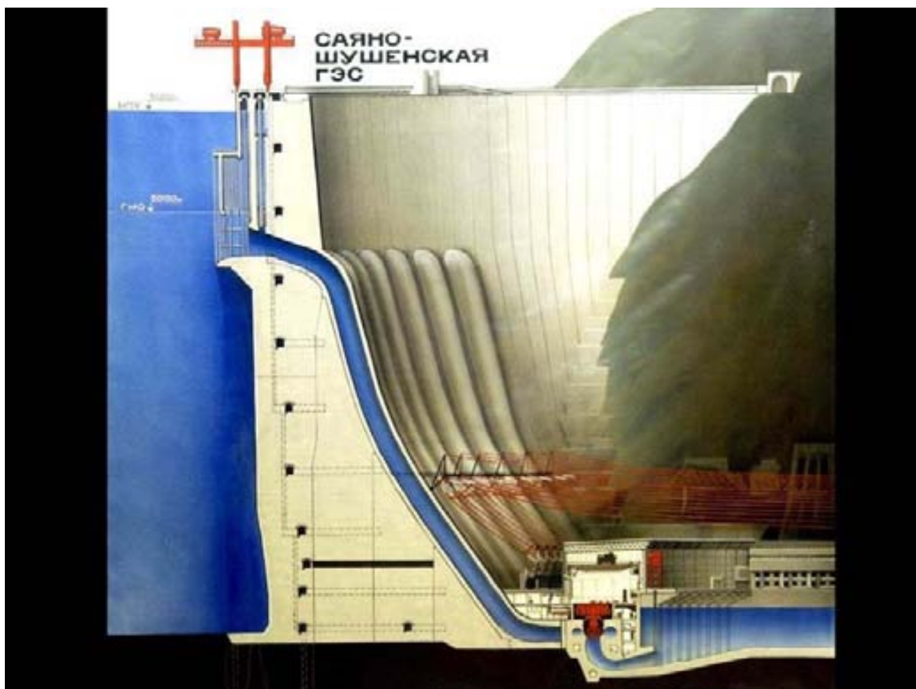
Рис.3.2. Разрез плотины и машинного зала СШГЭС
